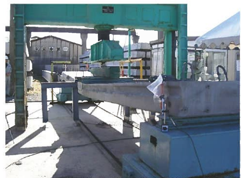
写真-1 曲げ載荷試験状況
