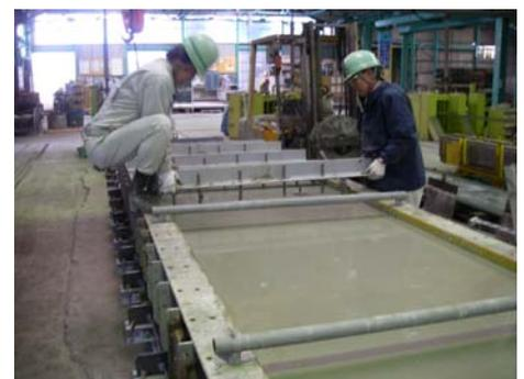
写真-8 浮き止めの取り外し
