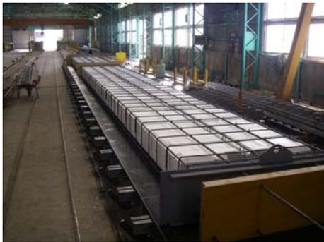
写真-4 鉄筋・EPS組立状況
