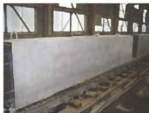
写真-5 脱型状況
