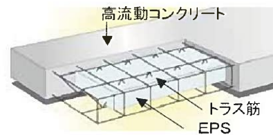
図-1 KSスラブ構造概念図
