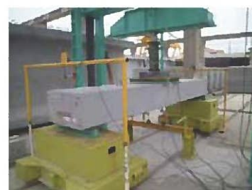
写真-7 載荷試験状況
