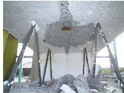
写真-17 破壊状況 (EPSなし)
