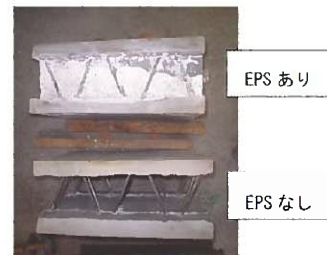
写真-3 押抜き供試体
