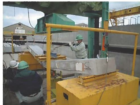
写真-8 はり載荷試験状況
