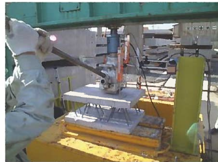
写真-10 押抜き載荷試験状況
