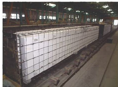
写真-15 プレストレス導入供試体製作状況
