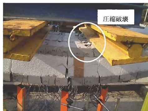
写真-9 破壊状況 (はり載荷試験)
