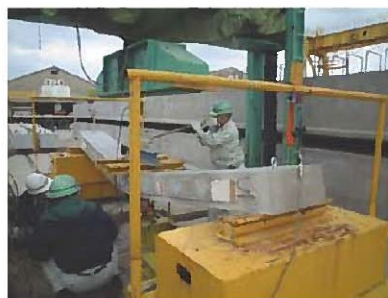
写真-3 はり載荷試験状況
