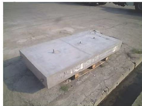
写真-14 打設性能試験供試体 (脱枠後)
