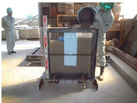
写真 2.1 自己充填性確認試験 （凹型試験体）
