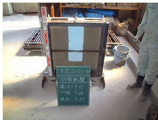
写真 2.2 自己充填性確認試験 打設完了
