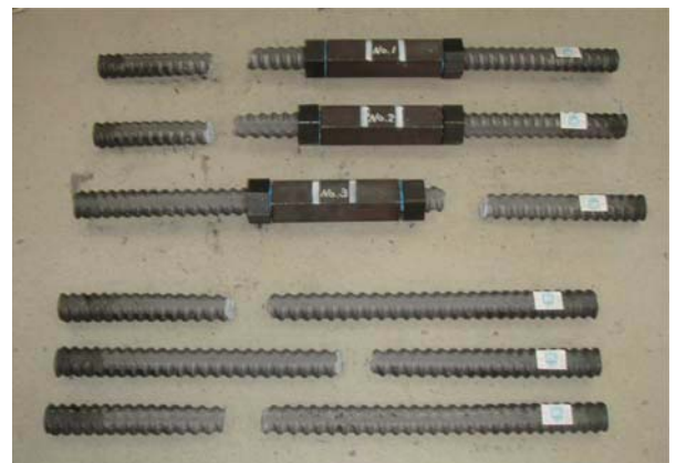
芯鉄筋引張試験供試体 (試験後)
