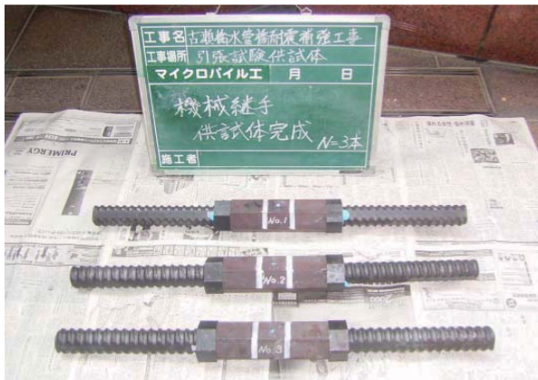
芯鉄筋引張試験供試体 (試験前)
