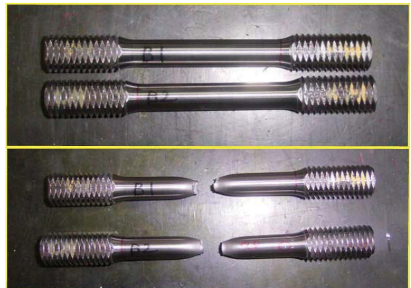
鋼管カップリング (API-P110) 素材引張試験供試体 (試験前後)
