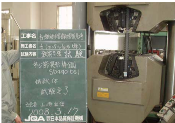
芯鉄筋引張試験状況 (棒鋼単体)
