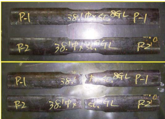
鋼管 (API-N80) 素材引張試験供試体 (試験前後)
