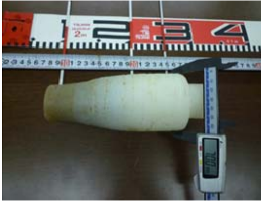
写真-2 拡径削孔形状
